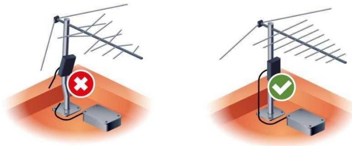
Другие формы дециметровых антенн — чаще просто маркетинговый трюк. Антенны необычной формы чаще всего работают только вблизи башни. А могут и создавать такие же проблемы при просмотре, как неподходящая антenna метрового диапазона.
